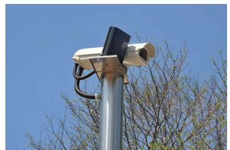
비명, 폭발음 등 소리를 감지하는 CCTV 설치 [서울신문 KIST 개발팀]
